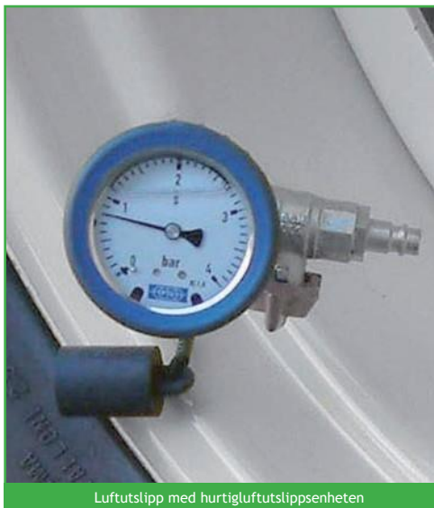
Luftutslipp med hurtigluftutslippsenheten
