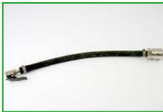
PTG-X-010-007: 1 personbiladapter for tilkobling av hurtiglufuttslippsenheten til en vanlig dekkventil (f.eks. tilhenger) bestående av en selvsperrende ventilplugg, 20 cm trykkluftslange og trykkluftkoblingsstykke (hunn)
