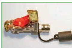
PTG-X-020-026: 1 tilhengerbremskoblingshode med trykkluftkoblingsstykke
